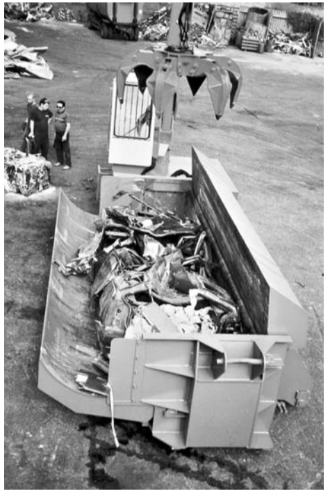
投入ボックスの容量の大きさと蓋開閉のハイスピードが処理能力をアップ
